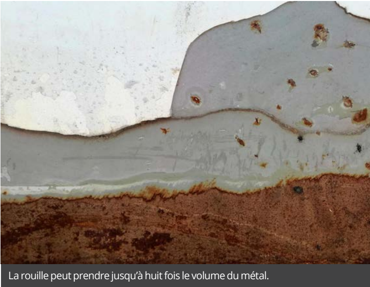
La rouille peut prendre jusqu'à huit fois le volume du métal.
