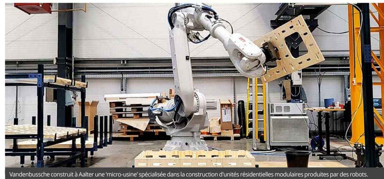
Vandenbussche construit à Aalter une 'micro-usine' spécialisée dans la construction d'unités résidentielles modulaires produites par des robots.
