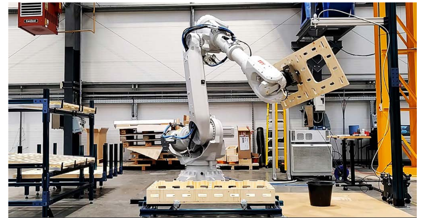
Vandenbussche bouwt in Aalter een gespecialiseerde 'microfabriek' om modulaire woonunits te bouwen die door robots werden geproduceerd.
