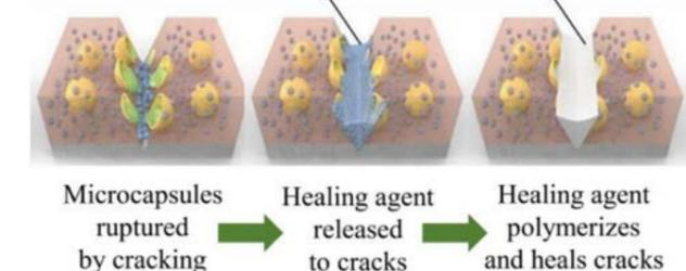
En cas de fissure, les nanocapsules s'ouvrent pour réparer le matériau "endommagé" -
