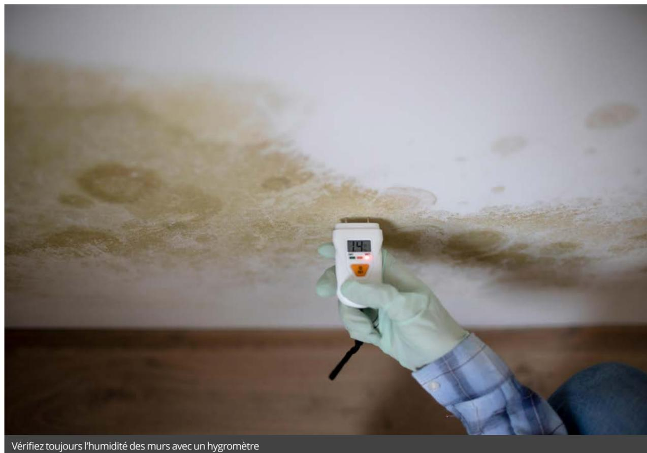
Vérifiez toujours l'humidité des murs avec un hygromètre
