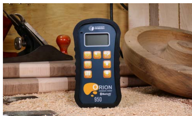
Les humidimètres sans broches (non invasifs) agissent en surface sans pénétration
