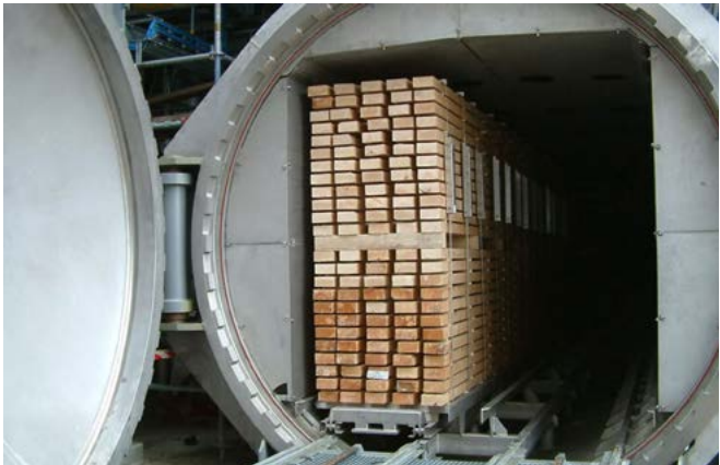
reSAWN TIMBER - L'acétylation limite l'absorption d'eau et améliore la stabilité dimensionnelle
