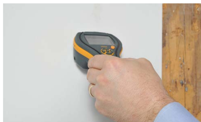
Les humidimètres tout-en-un utilisent une combinaison des deux types d'humidimètres précédents.
