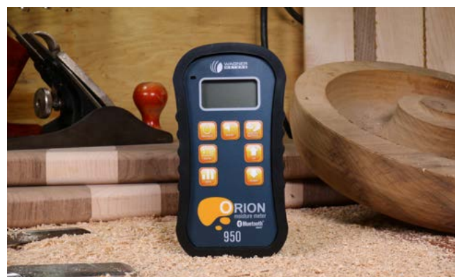
Pinloze vochtmeters werken op het oppervlak zonder het te penetreren
