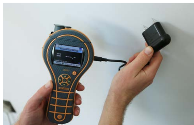
Pin-type vochtmeters meten het percentage vochtgehalte met twee contactpennen
