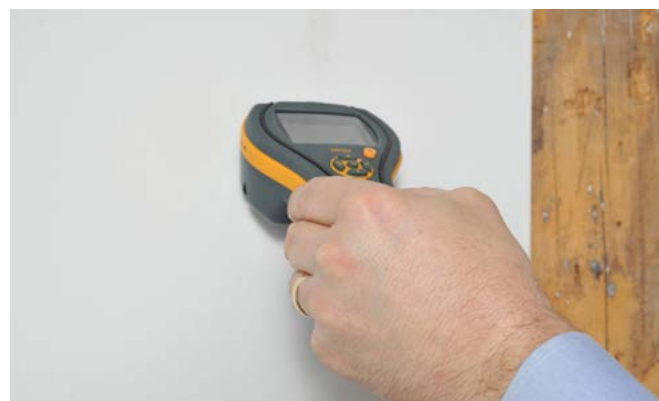
All-in-one vochtmeters maken gebruik van een combinatie van beide voorgaande types
